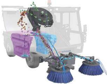
El sistema de 2 cepillos, con sus cepillos controlables independientemente, garantiza una movilidad absoluta en todas las situaciones de barrido. Los dos firmes brazos del cepillo, con amortiguadores integrados, ofrecen una anchura de barrido de hasta 2.900 mm.
