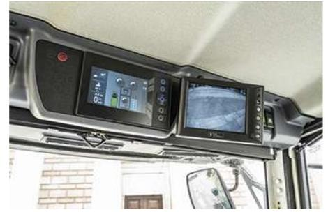
La unidad de barrido se controla a través del panel de control de la puerta con joysticks y pulsadores. Con la opción **Auto-Drive**, todas las funciones de barrido, así como los comandos de conducción en el modo de barrido, se pueden manejar cómodamente a través de un joystick multifuncional ergonómico. Controlar la conducción y el barrido con un solo elemento también conlleva una mayor seguridad y menos estrés.
