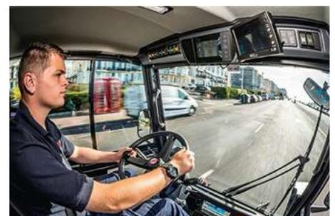
Es posible ver la información más importante de un solo vistazo en la **pantalla a color de la consola del techo**. Además, un mecánico puede realizar ajustes específicos de la máquina en la pantalla. Con la ayuda del **sistema de diagnóstico de a bordo**, es posible localizar de manera rápida y eficiente cualquier fallo.
