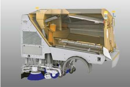
El gran volumen de la tolva, de 7,0 m<sup>3</sup>, permite recoger una gran cantidad de residuos. El suelo de acero inoxidable y las placas deflectoras de goma del interior de la tolva se combinan para garantizar una amplia vida útil prácticamente sin desgaste.
