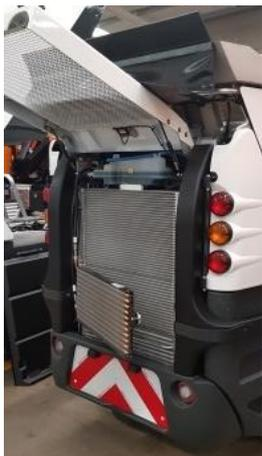
Ubicación de radiadores tras portón abatible en parte trasera de la máquina. Condensador de aire acondicionado abatible para una fácil limpieza de todos los elementos
