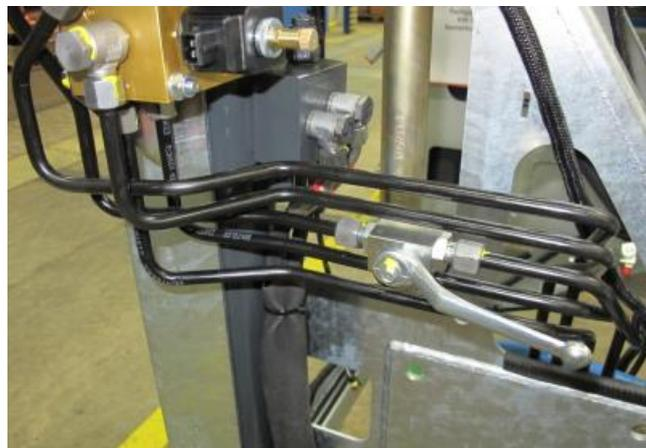
Ilustración 11-6 Conducciones hidráulicas rígidas
