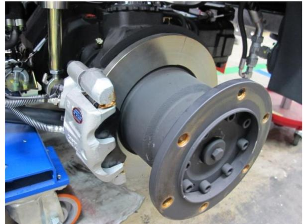
Ilustración 6-2 Frenos eje trasero
