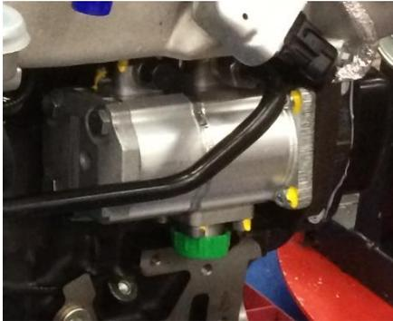
Una bomba doble de caudal fijo está montada en la toma de fuerza del motor.
