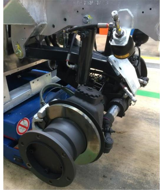
Ilustración 5-2 Eje delantero
