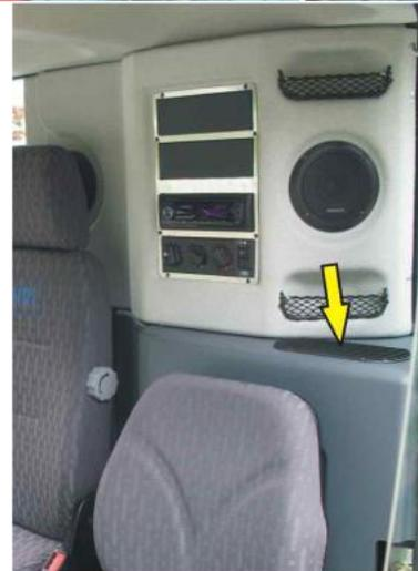
Ilustración 0-9 Toberas y rejillas de ventilación
