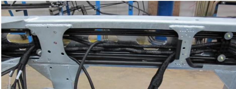
Ilustración 11-5 Conducciones hidráulicas rígidas
