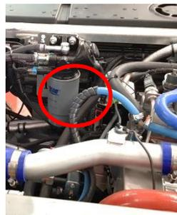
Filtro de gasoil, filtro de traslación y punto de llenado de aceite motor. Ubicación accesible.
