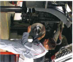
3. Verificación del estado de discos o tambores
